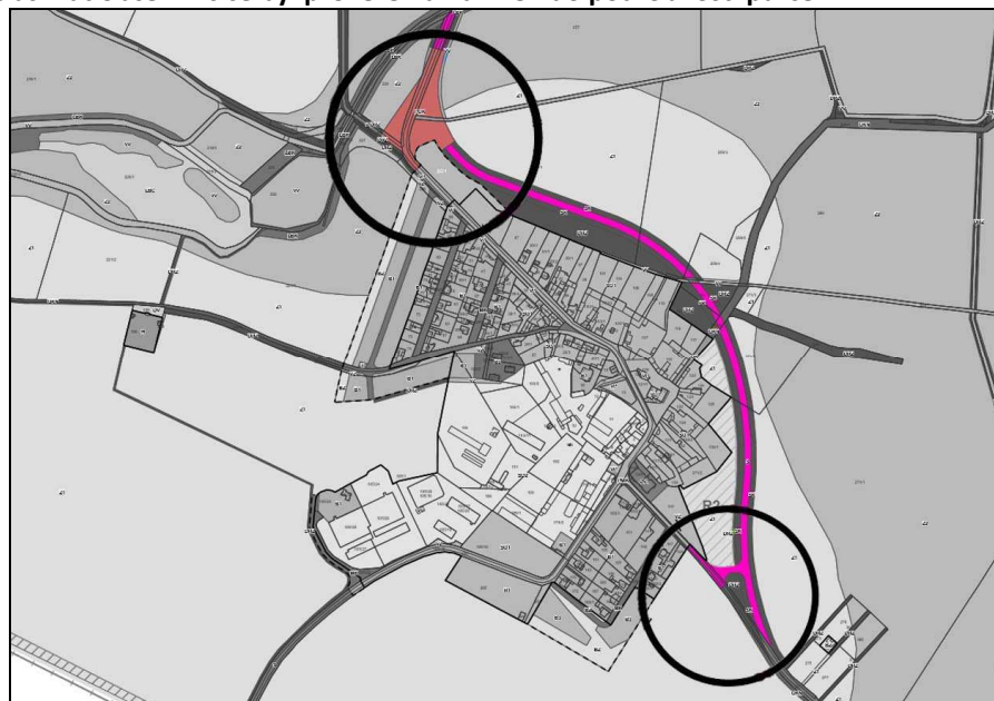
Výřez z výkresu č. 2 Hlavní výkres, kde jsou znázorněna i napojení obchvatu obce Milčice na stávající místní komunikace v obci.
